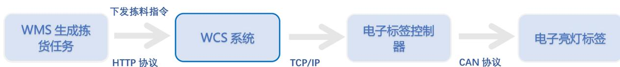
WCS 可以接收 WMS 一次下发多个作业指令单，此时，电子标签系统与之相应的多库位电子标签亮灯。
